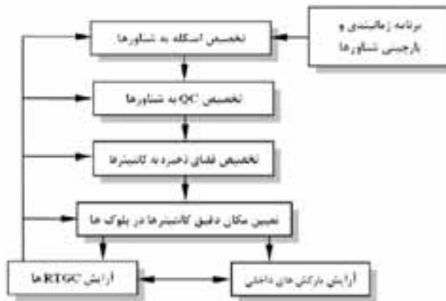
شکل ۱-۱- ساختار سلسله مراتبی تصمیمات عملیاتی در یک ترمینال کانتینر
