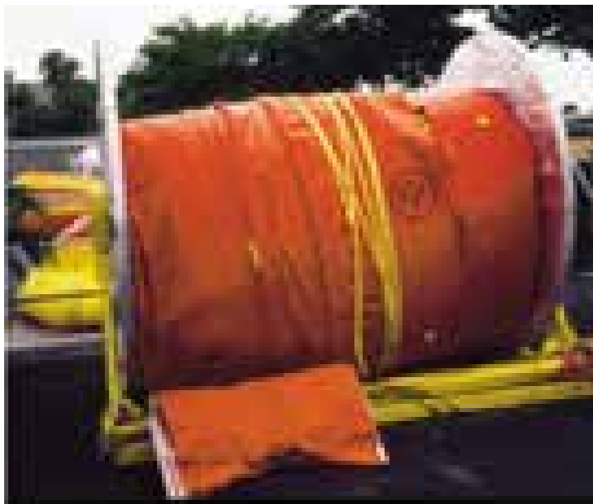
شکل 56: قرقه‌ها معمولاً برای بوم‌هایی که قابلیت باد کردن دارند، مورد استفاده قرار می‌گیرند.
