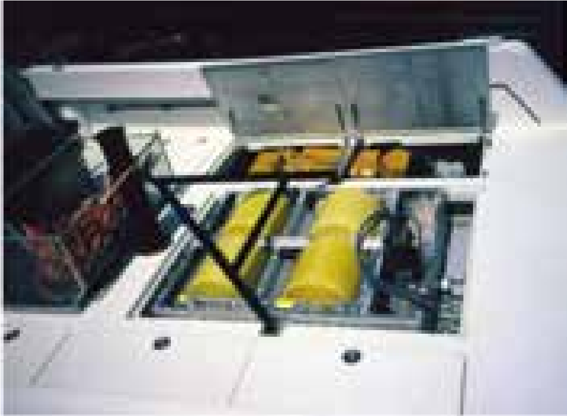
شکل 62- این عکس یک نوع از اسکیمر استوانه‌ای را نشان می‌دهد که در داخل شناور کوچک بکار گرفته شده است.
