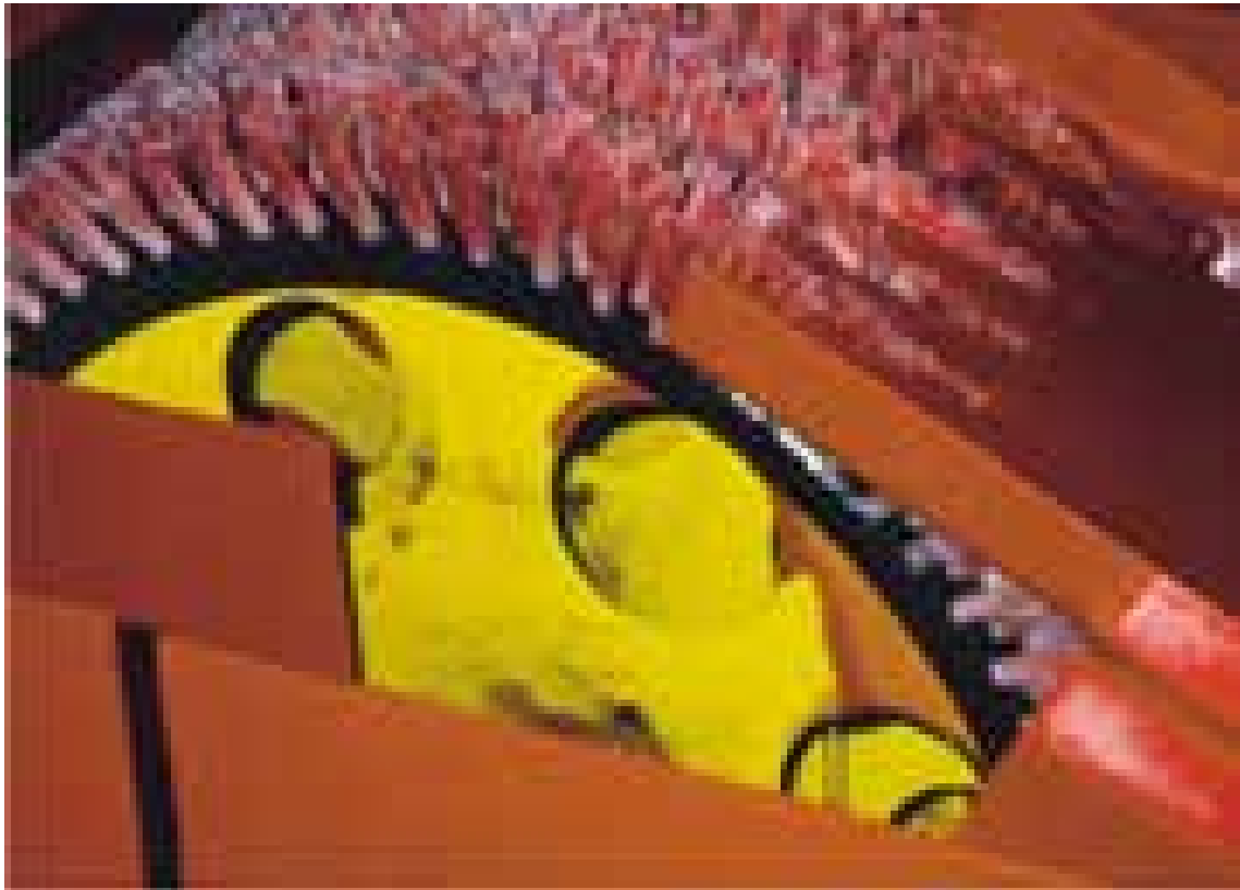
عکس 64: اسکیمبر بررسی برای جمع‌آوری روغن‌های روان کننده (Lubricating Oil)
