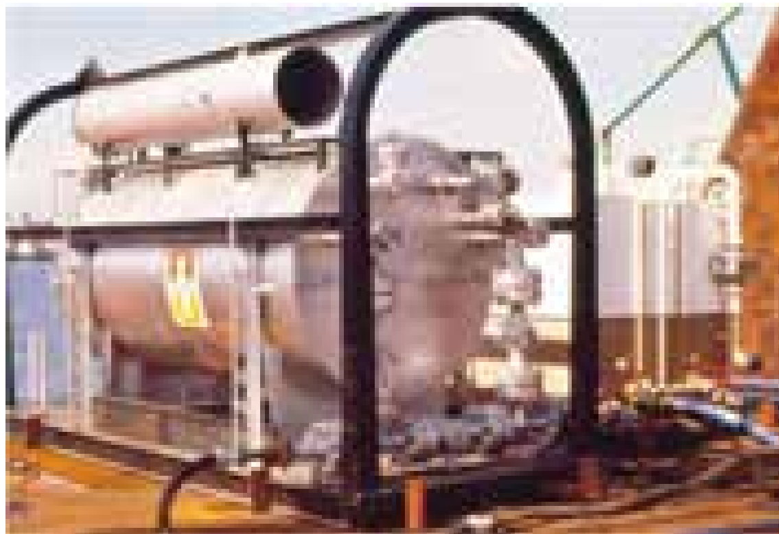
عکس 78: جدا کننده آب و مواد نفتی Oil- Water Separator
