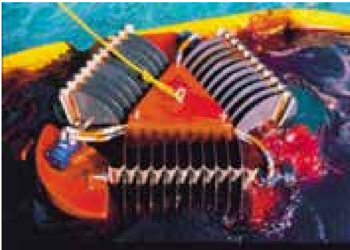
عکس 61: آزمایش اسکیمر برای جمع‌آوری نفت سبک
