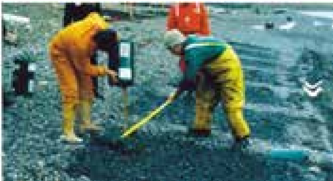
عکس 91: بکارگیری عوامل بیولوژیکی بر روی آلودگی‌های نفتی به منظور افزایش تجزیه مواد نفتی
