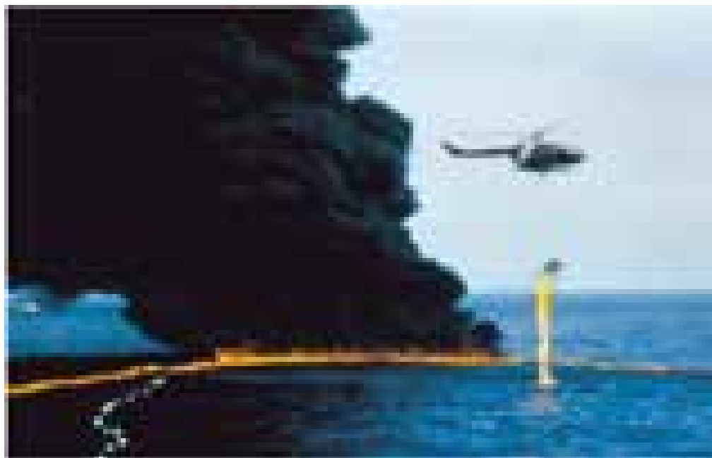
عکس 95: استفاده از هلی تورچ (Heli torch)، موثرترین راه برای شعله ور کردن لکه نفتی است
