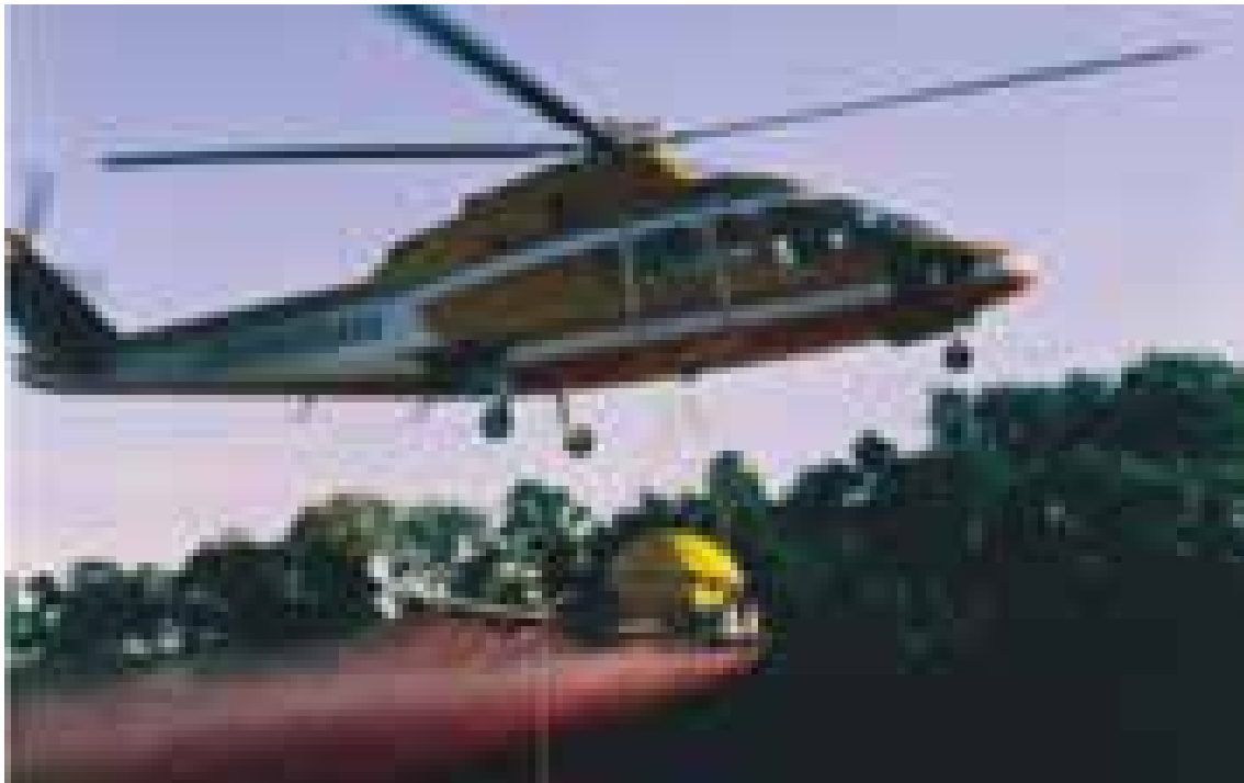
عکس 86: استفاده از هلی کوپتر برای پاشش مواد دیسپرسنت بر روی آب
