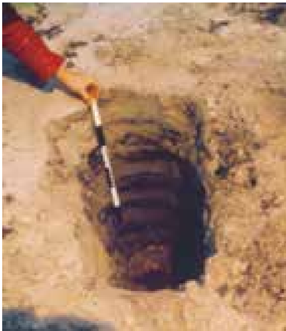
عکس 115: گودال حفر شده در ساحل، نشان دهنده لایه‌های نفتی مدفون در طول ساحل است.
