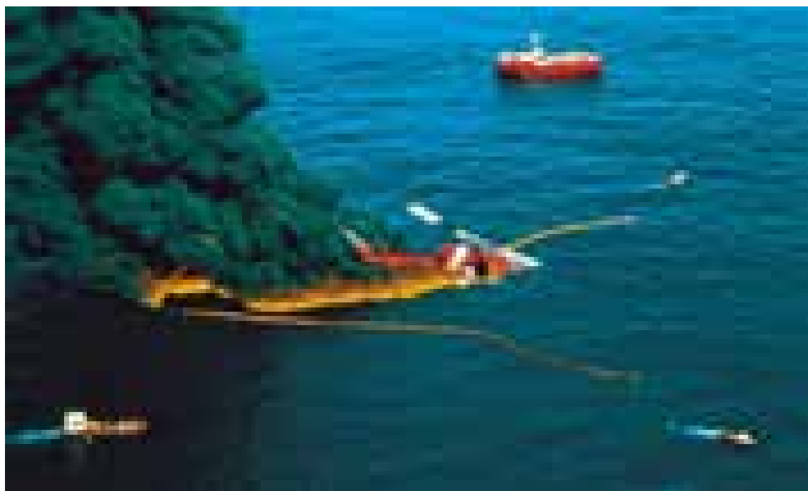
عکس 92: انجام آزمایش بزرگ سوزاندن آلودگی‌های نفتی در محل و در ساحل نیوفاندلند
