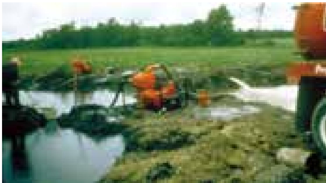
عکس 135: مواد نفتی به وسیله سیستم پمپاژ و خلاء جمع‌آوری می‌شوند.
