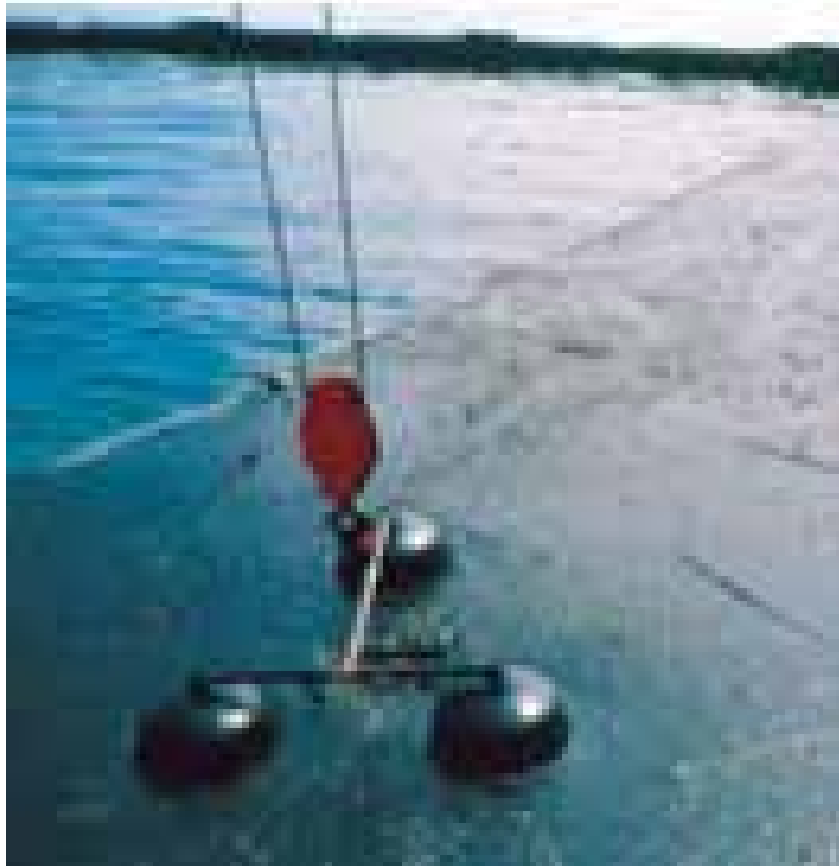
عکس 65: اسکیمبر مانعی برای جمع‌آوری نفت سوخته شده حاصل از حادثه نفتی‌هاون (HAVEN)
