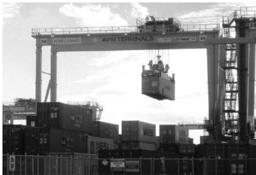
شکل ۳-۸) جرثقیل پشته سازی اتوماتیک
