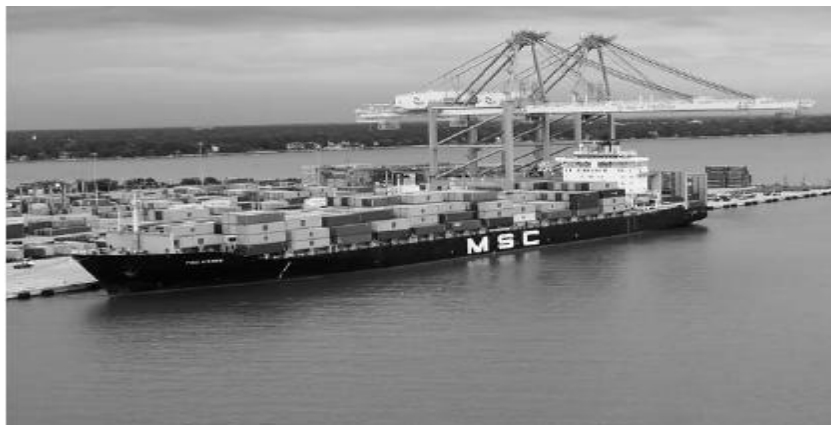
شکل ۳-۲) جرثقیل گردان دریا به ساحل
