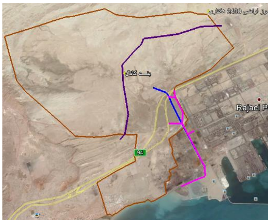
شکل ۶: وضعیت موجود خور غربی (رنگ آبی) وضعیت بعد طراحی خور غربی (رنگ صورتی) و بند کانال نسبت به اراضی ۲۴۰۰ هکتاری
